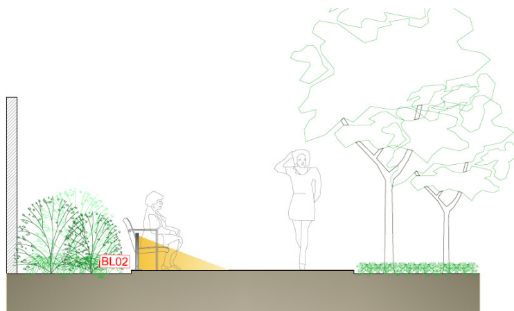
CAMINHO LATERAL - SAÍDA DE EMERGÊNCIA ESCALA 1:25
